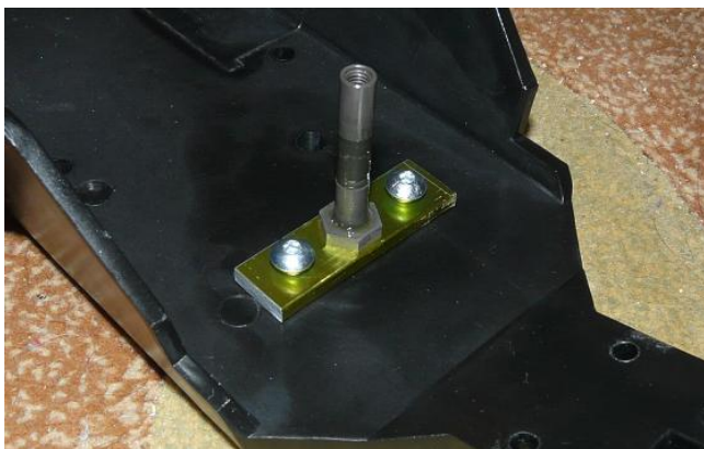
4 Spodný nosník servosavera... a jeho upevnenie...
