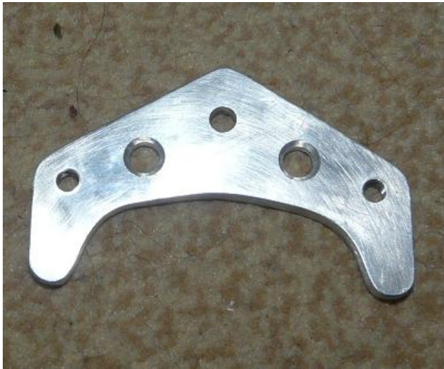
3 Vrchný nosník servosavera... a jeho upevnenie k šasi...
